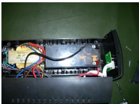
5 - Tira la vecchia batteria e mettere la nuova attaccando un'etichetta con la data dell'inserimento della nuova batteria
